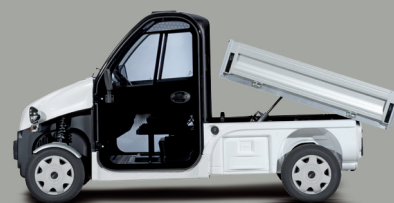
Be Sun L3 Valník s hydraulickým sklápěním
