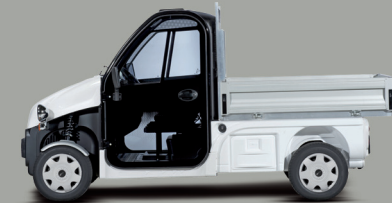
Be Sun L3 valník se zadním čelem, pevnými bočnicemi a držákem na nářadí
